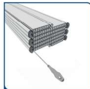
1- Retire as tampas de junção da parte inferior da porta (ledo que não possui roletes).
