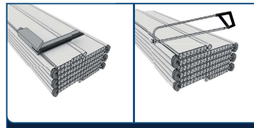
2- Marque o local de corte com um esquadro e corte na altura pretendida.
